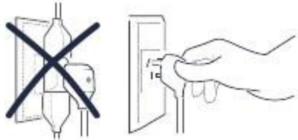
El cable de suministro de energía del artefacto tiene su respectivo enchufe diseñado con una capacidad de corriente equivalente a su potencial nominal. Por ningún motivo lo cambie o empalme un cable de suministro diferente; esto podría deteriorarlo y causar cortocircuito. Evite que los cables eléctricos de otros aparatos toquen con partes calientes del horno. Antes de sustituir cualquier elemento eléctrico, desconecte el cable de alimentación de la red eléctrica.
